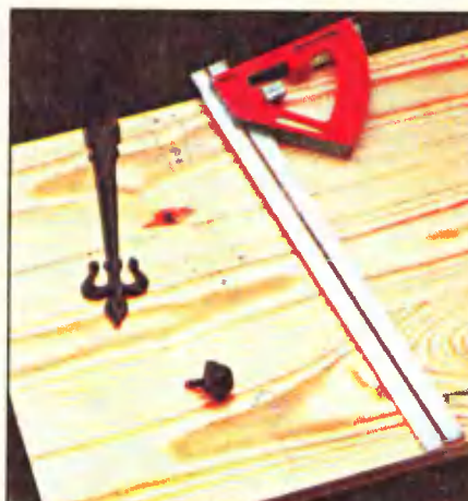
Декоративную фурнитуру крепят на шурупах. Головки крепежных шурупов можно украсить декоративными колпачками.
